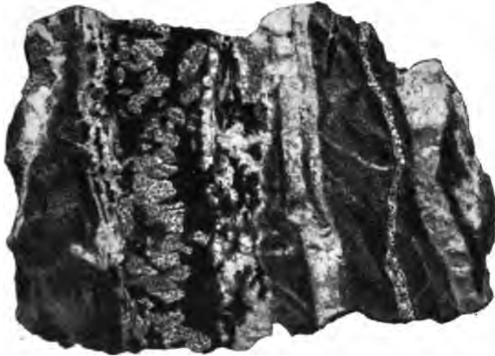
Fig. 1. Gangfüllung von Mitterberg bei Bischofshofen (Salzburg), bestehend aus a) Erz = Kupferkies (schwarz), b) Gangart = Quarz (weiß) und Spateisenstein (weiß mit schwarzen Punkten), c) Ganggestein = dunkler Schiefer (hell- bis dunkelgrau).
